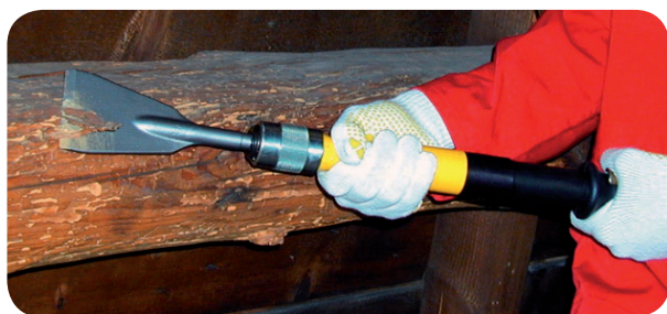
Bûchage du bois (avec le Scrapair pneumatique)
